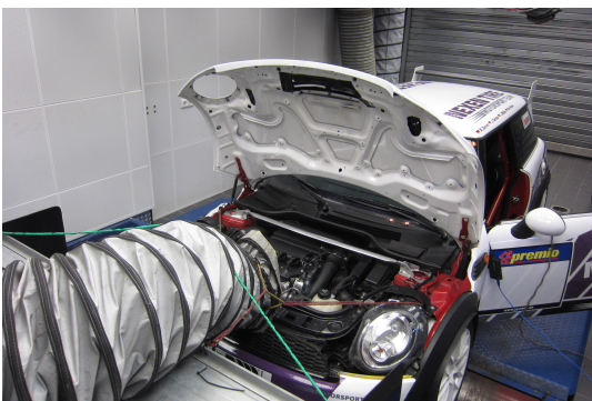
Der NEXEN TIRE Mini auf dem Leitungsprüfstand
